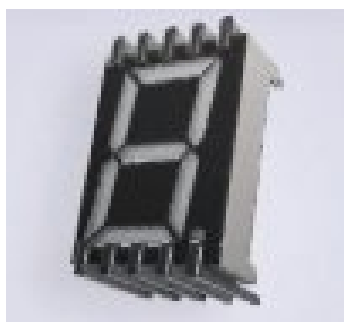
Рисунок 1 – Внешний вид семисегментного индикатора, обозначения сегментов и распиновка.
