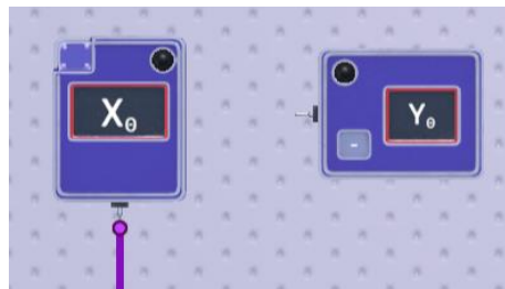
Рисунок 2 – Внешний вид источника и потребителя цифрового сигнала.
